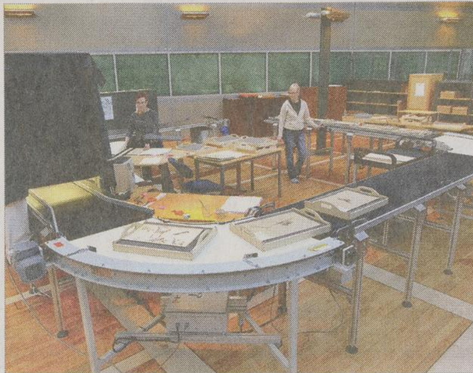
Päivi Stranden ja Hanna Araja-Matilainen Digitalariumin linjastolla. Näytteet kulkevat sykäyksittäin mustan hupun alle kuvattaviksi. Automaatio takaa tasalaatuisuuden ja nopeuden.
